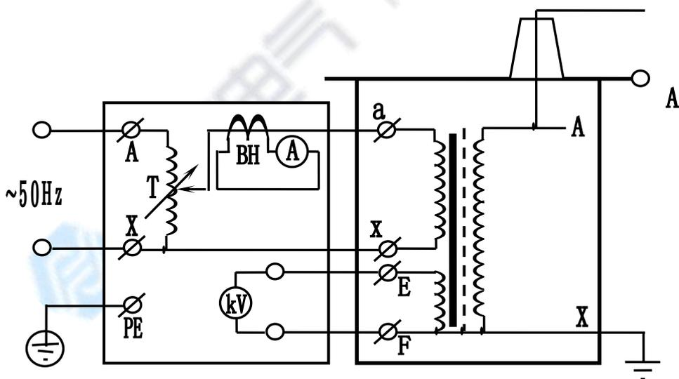
图 1：控制箱（台）工作原理
